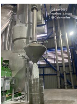
ภาพที่ 2.2-3 ระบบ Cyclone บริเวณหน่วยผลิต เม็ดพลาสติกพีที (SSP)
